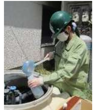
新規設置浄化槽採水の様子
