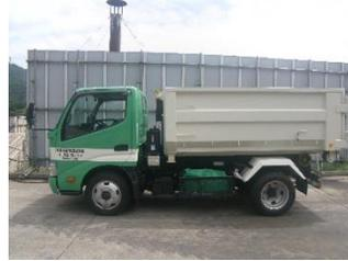
お客様のところに専用コンテナを設置し、廃プラスチック類や脱水汚泥等の廃棄物を収集運搬する車両です。有機汚泥には密閉式コンテナも用意しています。
