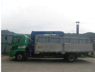
トラックに取付けられたクレーンを使って、重量物を吊上げて積載する車両です。
