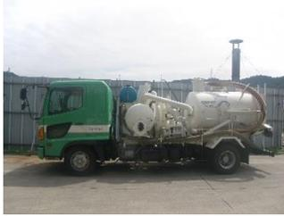
吸引車は、大風量のブロフでタンク内を負圧にし、ホースの先から吸引します。液体物だけでなく、泥状物や粒子状の固形物の吸引が可能です。
