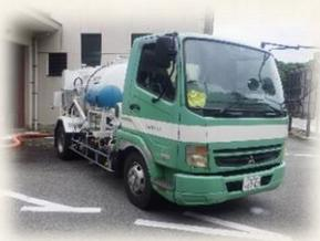
吸引車は、大風量のブローでタンク内を負圧にし、ホースの先から吸引します。液体物だけでなく、泥状物や粒子状の固形物の吸引が可能です。
