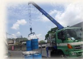
トラックに取付けられたクレーンを使って、重量物を吊上げて積載する車両です。
