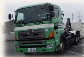
お客様のところに専用コンテナを設置し、廃プラスチック類や脱水汚泥等の廃棄物を収集運搬する車両です。有機汚泥には密閉式コンテナも用意しています。
